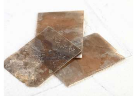
الشكل (17/ أ): معدن المايكا، انقسام في اتجاه واحد.
