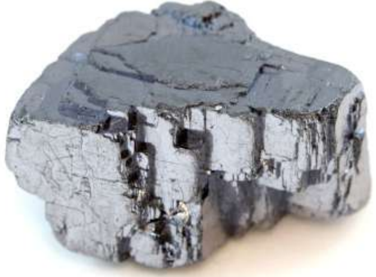
الشكلُ (16/ أ): يمتازُ معدنُ الغالينا بريقه الفلزيِّ.
