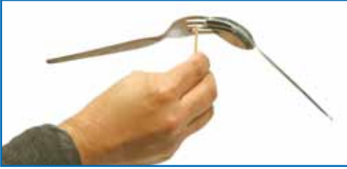
الشكل (أ/٥-٥): نظام مكون من شوكة وملقعة فى حالة اتزان ميكانيكى.
