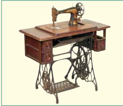
الشكل (٤-٨): آلات تحوّل الحركة التوافقية البسيطة إلى حركة دورانية.
