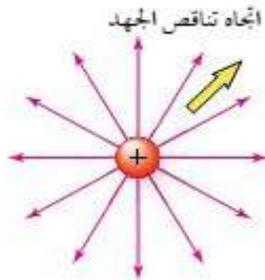
\* إن إشارة الجهد تساعدنا على ترتيب النقاط من الأقل جهداً إلى الأعلى جهداً ، إن اتجاه المجال الكهربائي يكون دائماً باتجاه تناقص الجهد الكهربائي . ( لاحظ الشكل )
