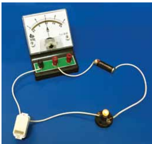
الشكل (٦-٤): توصيلُ الأميترِ بالدارةِ الكهربائيةِ.
