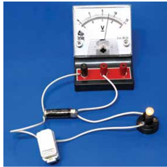
الشكل (٦-٨): توصيل الفولتميتر بالدارة.
