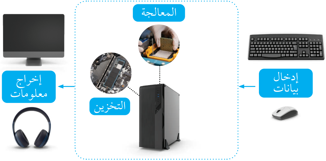
الشكل (1-1): رسمٌ توضيحيٌّ لمبدأ عمل جهاز الحاسوب.
