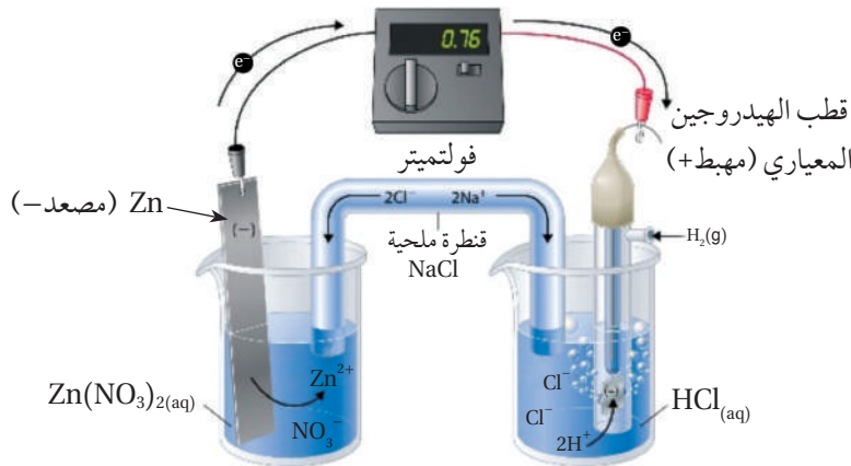
الشكل (7): خلية جلفانية قطباها الخارصين والهيدروجين المعياريان.
