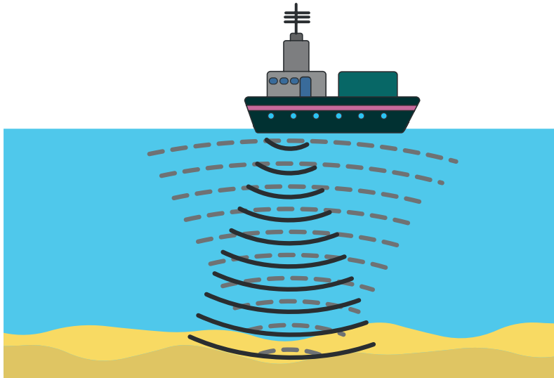
الشكل (5): استخدم العلماء أجهزة السونار لقياس أعماق المحيطات.
