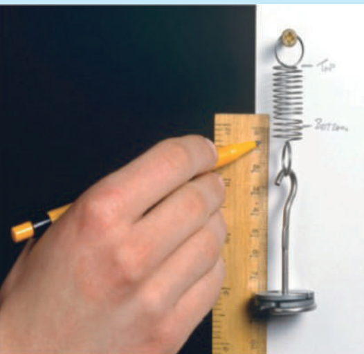
الشكل (12): دراسة العلاقة بين قوة الشدّ والاستطالة تجريبيًا. أمثل النتائج الواردة في الجدول بيانيًا، القوة على محور (x)، والاستطالة على محور (y).
