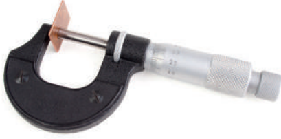
الشكل (3): قياس سُمْكِ صفيحة باستخدام الميكروميتر.
