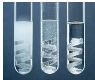
الشكل (3): تفاعل فلز المغنيسيوم مع حمض \text{HCl} .
