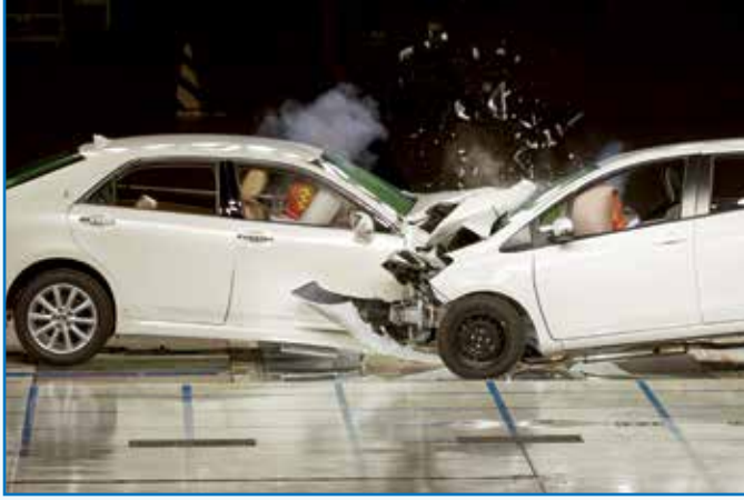
تصادم رأس برأس في اختبار تصادم.
