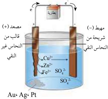
الشكل (20): تنقية النحاس بالتحليل الكهربائي.
