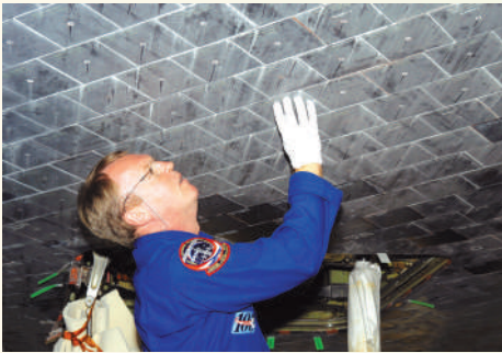
الشكل (٦-١٧): تفقّد القطع العازلة بعد الرّحلة.
