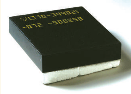
الشكل (٦-١٦): تغليف مقدّمة الموك بالقطع العازلة.
