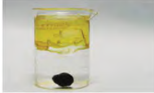
الشكل (14): الاختلاف في كثافة المواد يجعلها تطفو أو تنغمر.
