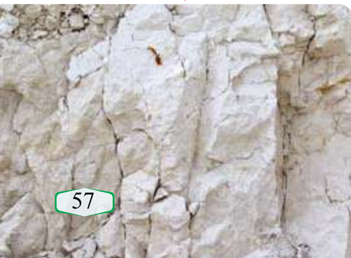
▼ يُستخدم الحجر الجيري النقي في صناعة الأسمنت.
